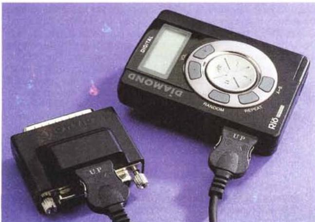
Il cavo di connessione con il computer assomiglia molto a quelli utilizzati nei telefonini, a causa del connettore multipolare extrapiatto. L'interfaccia verso il computer è molto comoda e consente di utilizzare contemporaneamente anche la stampante.
